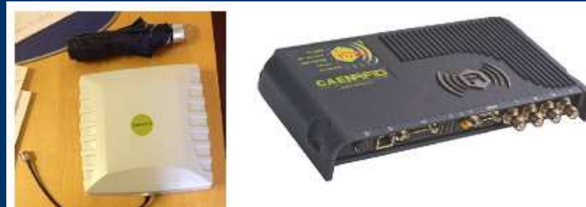
Antenna Rfid (su bici) e Centralina UHF Rfid
