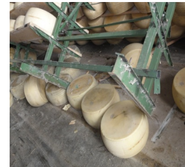
Collasso di scaffalature in acciaio non adeguatamente collegate alla struttura ed indotte al collasso dal carico sostenuto
