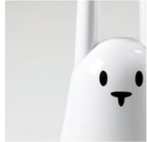
Nabaztag ha un **bottono sulla testa**, due orecchie con fissaggio magnetico mosse da **motori passo-passo** e dotati di **encoder** per leggerne la posizione via Software, **5 LED RGB**, **un lettore RFID**, una **scheda audio** con **microfono** ed **altoparlante** ed una scheda WiFi. E' controllato da un server remoto, originariamente programmato in Ruby on Rails, su cui ogni proprietario di Nabaztag deve caricare plugin e "programmarli".
