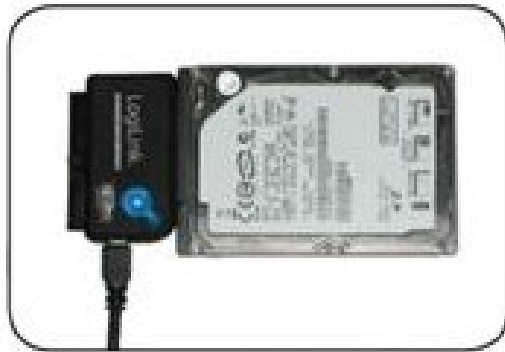
IDE 44Pin for 2.5"HDD
