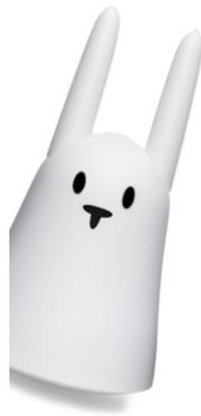
Karotz viene rilasciato nell'Aprile 2011 da Mindscape. E' dotato di webcam, di porta USB (che puo' essere usata anche per l'alimentazione oltre che per collegare periferiche) e di 256 MB di RAM on board. Un pc con le orecchie.
