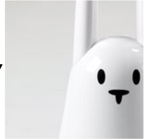
Nabaztag possiede un bottone sulla testa, due orecchie con fissaggio magnetico mosse da motori passo-passo e dotati di encoder per leggerne la posizione via Software, 5 LED RGB, un lettore RFID, una scheda audio con microfono ed una scheda WiFi.
